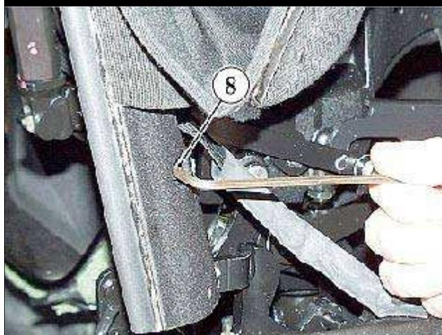
● 松开将外侧后拱末端紧固到运动机构支架的螺钉(8)。
