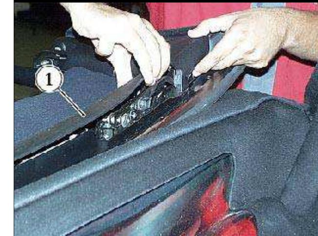
● 手动折回前部车顶框架并通过从固定夹中滑出拆卸下部面板 (1)。
